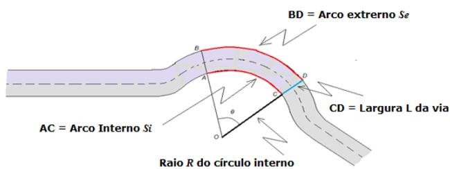
Figura 02: Esquema Ilustrativo do Método dos Comprimentos dos Arcos
