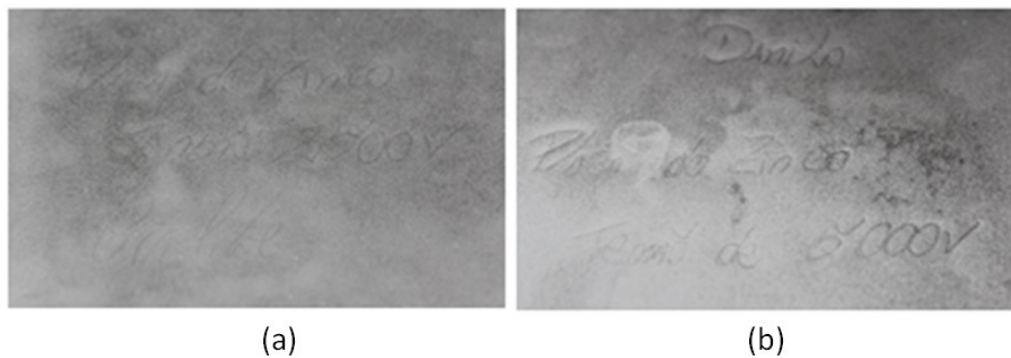
Figura 3 - Método II – Marcas Realçadas com Grafite Sobre a Placa de Zinco – (a) Com ddp 2500V; (b) Com ddp 5000V.
